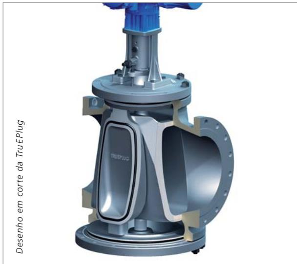
Conforme o plugue se eleva e gira da posição aberta para a fechada, é mantida uma distância entre o Sapata e o corpo da válvula, permitindo o movimento livre e evitando riscos.
