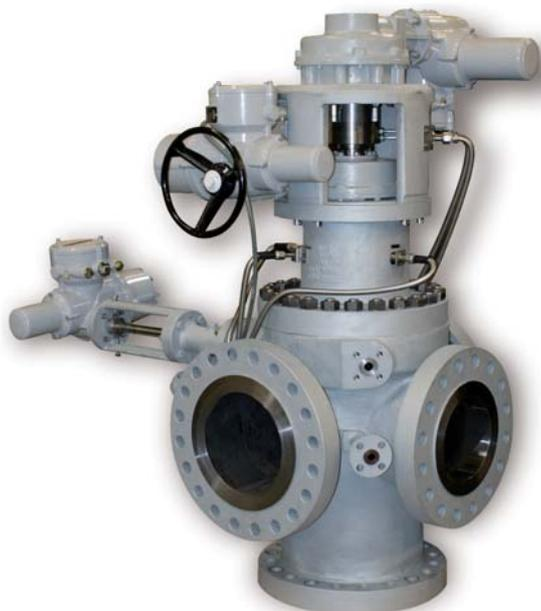
A SwitchPlug consiste de apenas algumas peças móveis – corpo, plugue e atuador, sendo, portanto, altamente confiável. Não há folga entre o plugue e o corpo da válvula onde partículas do fluido ou de coque possam assentar, danificar a tubulação ou riscar a válvula. A lavagem é, portanto, somente necessária quando o plugue está em movimento.
