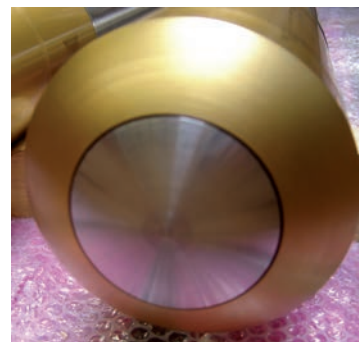
Cabeza de pistón con revestimiento de carburo de tungsteno
