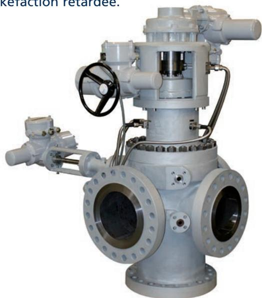
La vanne SwitchPlug™ est composée de peu de pièces en mouvement, le corps, le boisseau et l'actionneur, et font qu'elle est d'une grande fiabilité. Il n'y a pas de jeu entre le boisseau et le corps de vanne où des particules de coke ou du fluide, pourraient se déposer, endommager la tuyauterie ou rayer la vanne. Le rinçage est nécessaire seulement lorsque le boisseau est en mouvement.
