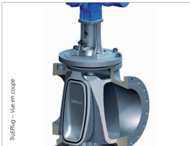
Lors de la levée et rotation du boisseau, de la position ouverte à fermée, un jeu est maintenu entre l'insert et le corps de vanne permettant un mouvement libre et évitant les rayures.
