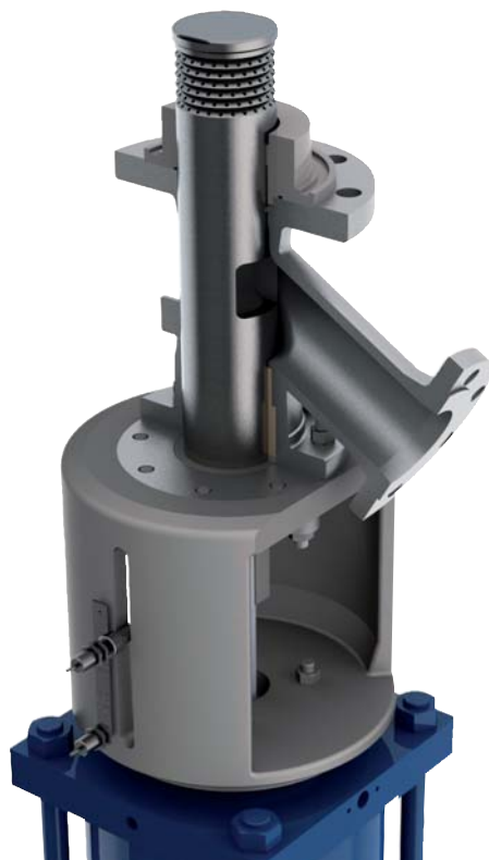
Válvula de injeção a pistão 27SE com pistão oco e até 2.000 furos para vazões elevadas
