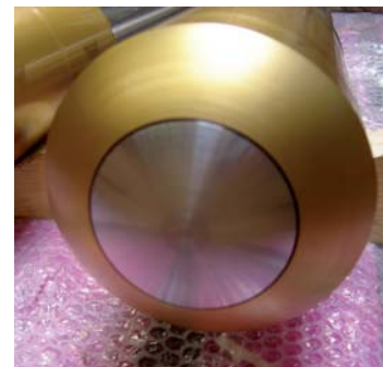
Cabeçote de pistão com revestimento de metal duro com tungstênio
