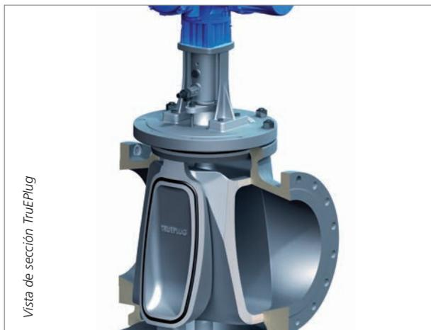
Cuando el macho se levanta y gira cambiando de posición, se mantiene una separación entre el cuerpo y el macho, permitiendo una maniobra sin rozamiento.
