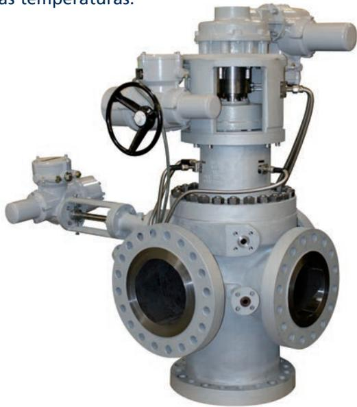
La SwitchPlug se compone de pocas partes móviles – cuerpo, macho y actuador – y es por tanto altamente fiable. No existe separación entre el macho y el cuerpo de la válvula donde el fluido o partículas de coque se puedan posar, dañar la tubería o marcar la válvula. Sólo se requiere del flushing cuando el macho está en movimiento
