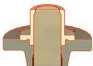
Modèle 28KS Portée d'étanchéité métallique dans la cuve
