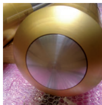
Tête de piston avec un revêtement en carbure de tungstène
